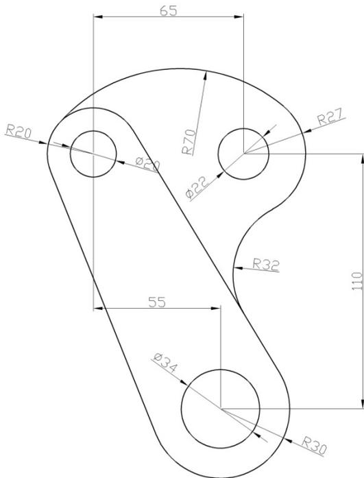
1. Dibuja la siguiente figura a escala 1:1 señalando los centros de todas las circunferencias y los puntos de tangencia. (figura izquierda)
